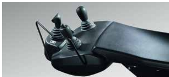
Změna směru jízdy páčkou na loketní opěrce nebo sloupku volantu, možné také s D2 pedálem pojezdu
