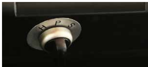
Selektor jízdního režimu (H-P-S) pro snadné přizpůsobení akcelerace a efektu automatického brzdění podle preferencí jednotlivých řidičů
